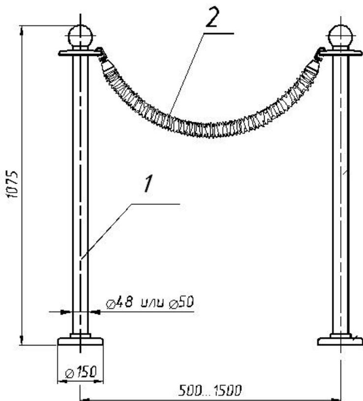
**Рис. 13. Конструкция, габаритные размеры и комплектация ограждений ОСЗБ, ОСЗЦ**
