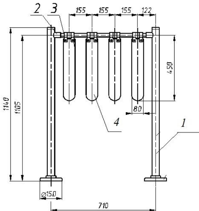
**Рис. 6. Конструкция, габаритные размеры и комплектация ограждений ОТ1**
