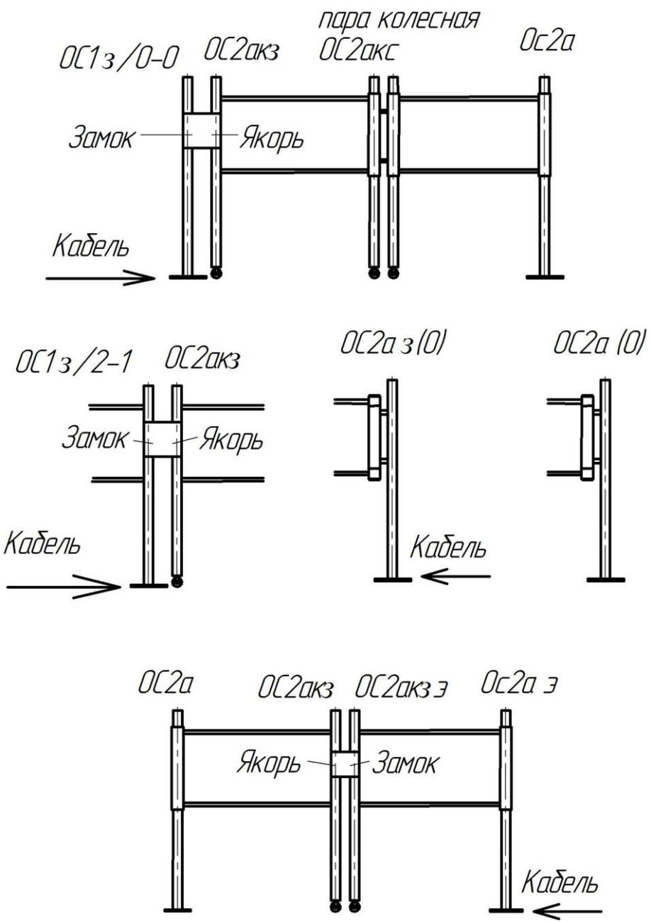
Рис. 11. Виды стоек ограждений с электромагнитным замком
