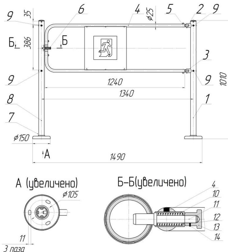
**Рис.16 Габаритные и установочные размеры калитки антипаники «Ростов-Дон К12»**
