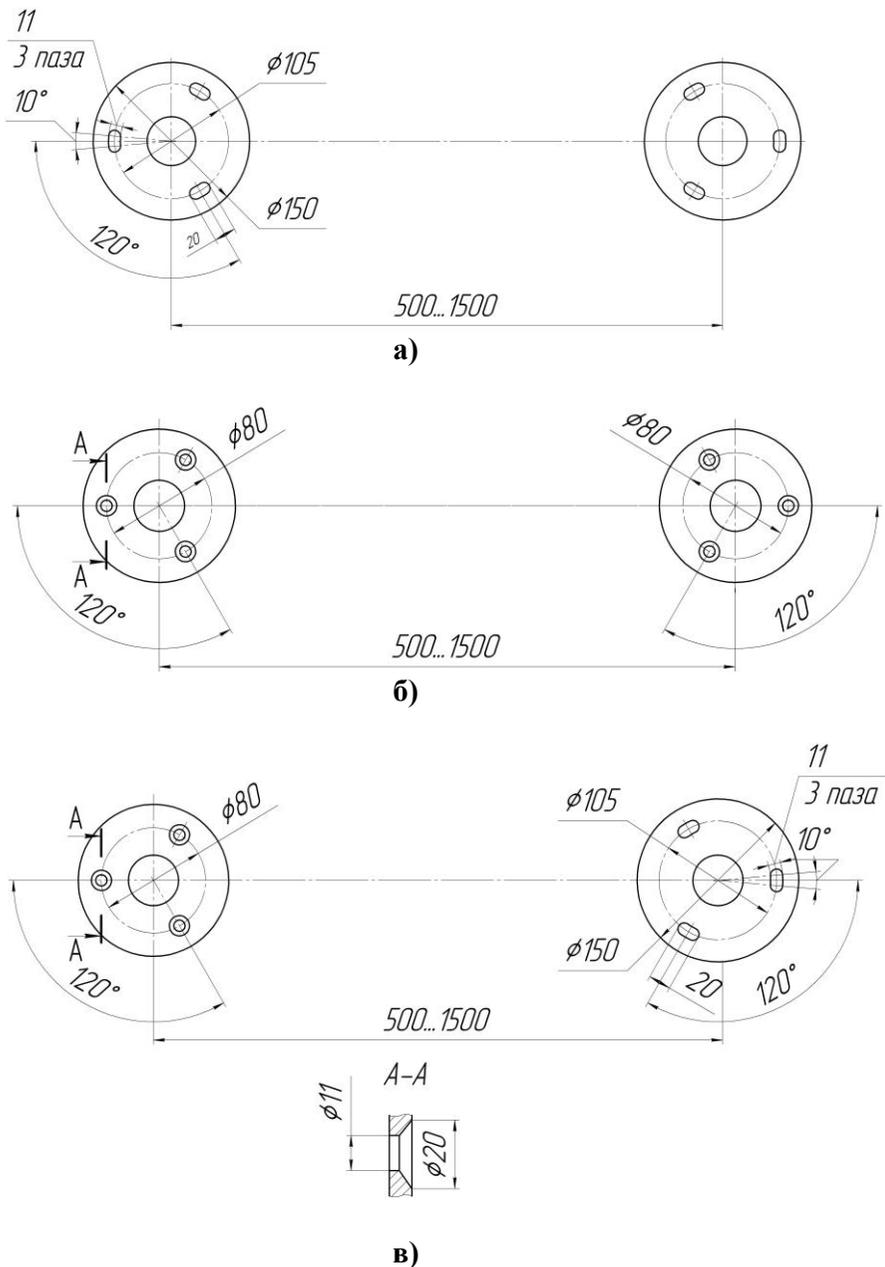
**Рис. 18. Установочные размеры стоек стационарных ограждений:**
