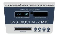
Рабочая частота позволяет одновременно работать нескольким металлодетекторам, для первого и каждого последующего детектора необходимо выбрать соответствующую рабочую частоту, чтобы исключить взаимовлияние друг на друга, а также уменьшит влияние на изделия внешних электромагнитных помех
