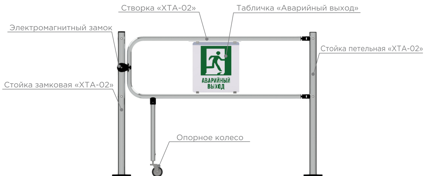
Рисунок 6.1. Состав секции «Антипаника» с электромагнитным замком «ХТА-02»
