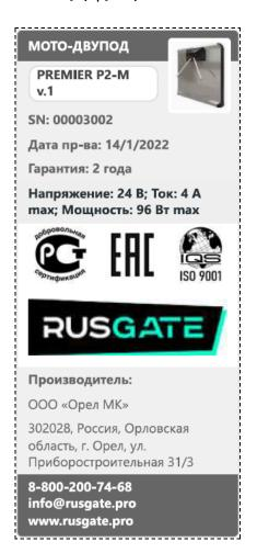
Турникеты имеют физическую маркировку в виде ламинированных этикеток, расположенных внутри корпуса турникета под Передним кожухом. Чтобы считать информацию с этикетки необходимо демонтировать Передний кожух, предварительно отсоединив преграждающие планки. Этикетка может иметь следующий вид:
