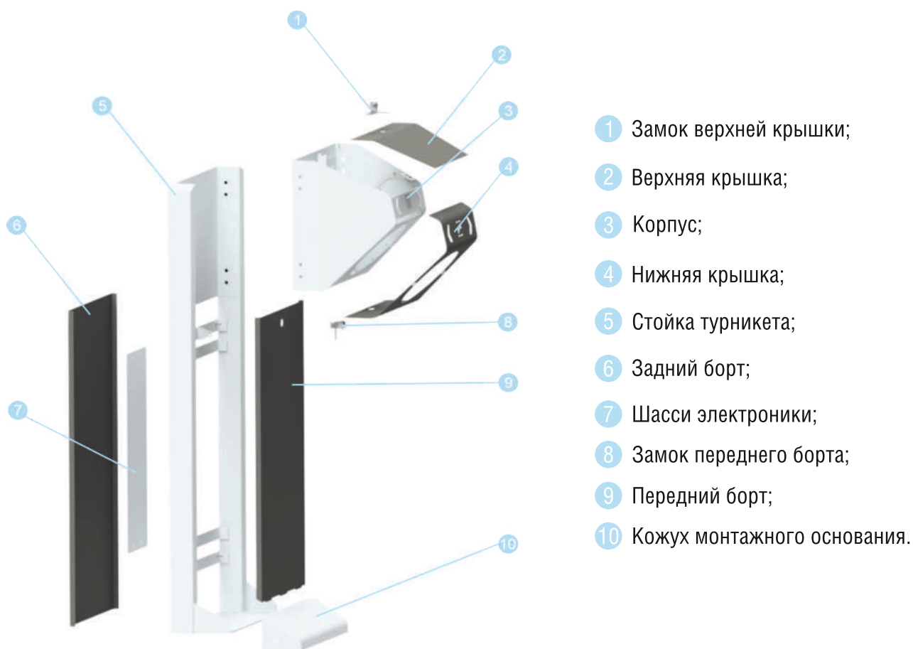
Рисунок 6.1.1 Устройство корпуса турникета
