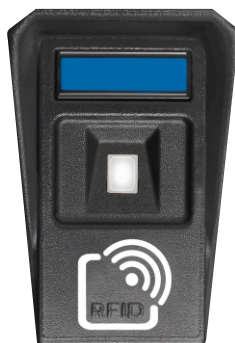
Рисунок 14.4.1 – Модуль учета рабочего времени.
