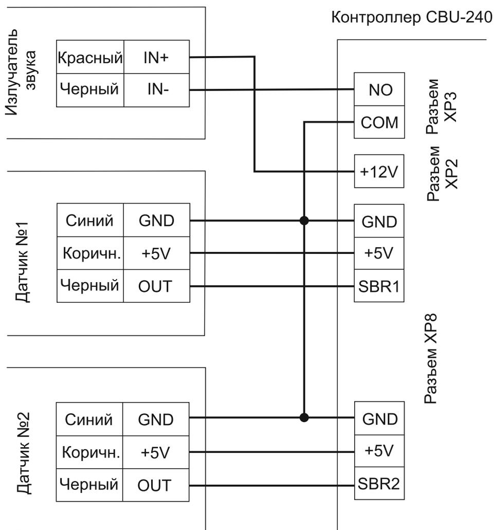
Рисунок 6.7.3 Схема подключения модуля датчика несанкционированного прохода
