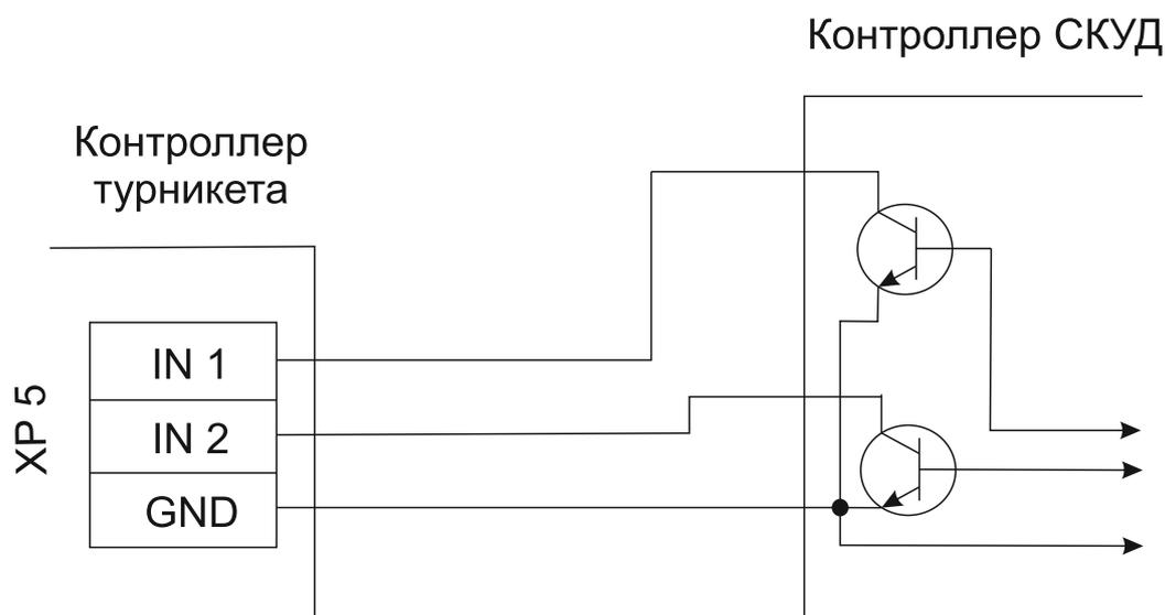
Рисунок 8.2.3 Схема подключения турникета к СКУД «открытый коллектор»
