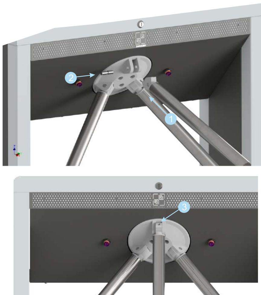
Рисунок 7.5.1 Установка преграждающих планок
