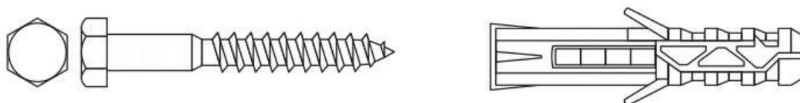
Рисунок 7.4.1 Шуруп с шестигранной головкой «Глухарь» с дюбелем
