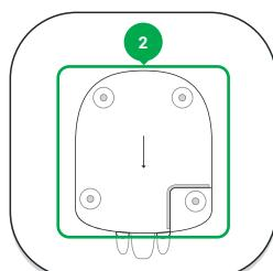
2 - Крепежная панель SmartBracket (перфорированная часть необходима для срабатывания таймера при попытке оторвать ReX от поверхности)
