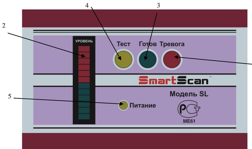
**1** – Индикатор тревоги. Также при тревоге включается звуковая сигнализация. Прибор имеет 33 зоны обнаружения. Индикация местоположения обнаруженного предмета осуществляется на боковых панелях прибора. Вся высота панели разделена на 11 зон. Если предмет обнаружен слева, включаются индикаторы левой панели в соответствующем уровне, если справа, то правой панели, если по центру, включаются индикаторы обеих панелей.
