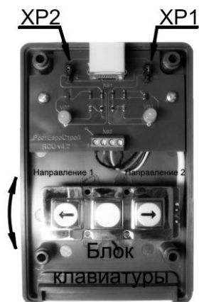
Вид пульта со снятой крышкой
